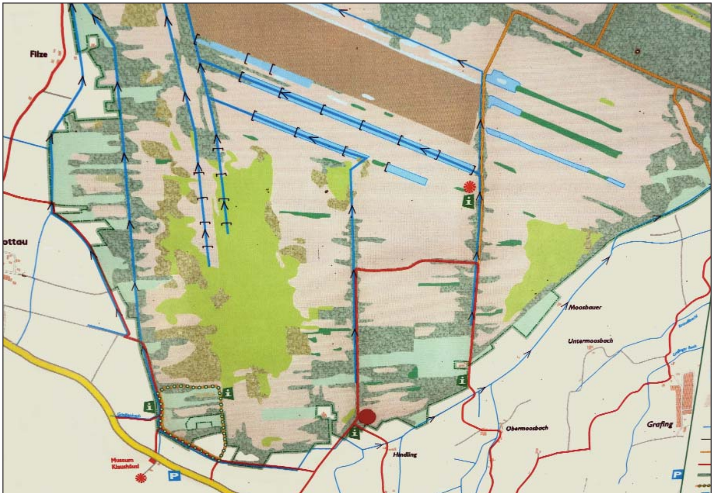
Abb. 8: Zur künstlichen Wiedervernässung des Südtails der Kendlmühlfilzen wurden bestimmte Gräben im Zentrum der Filzen durch Staudämme verschlossen.
