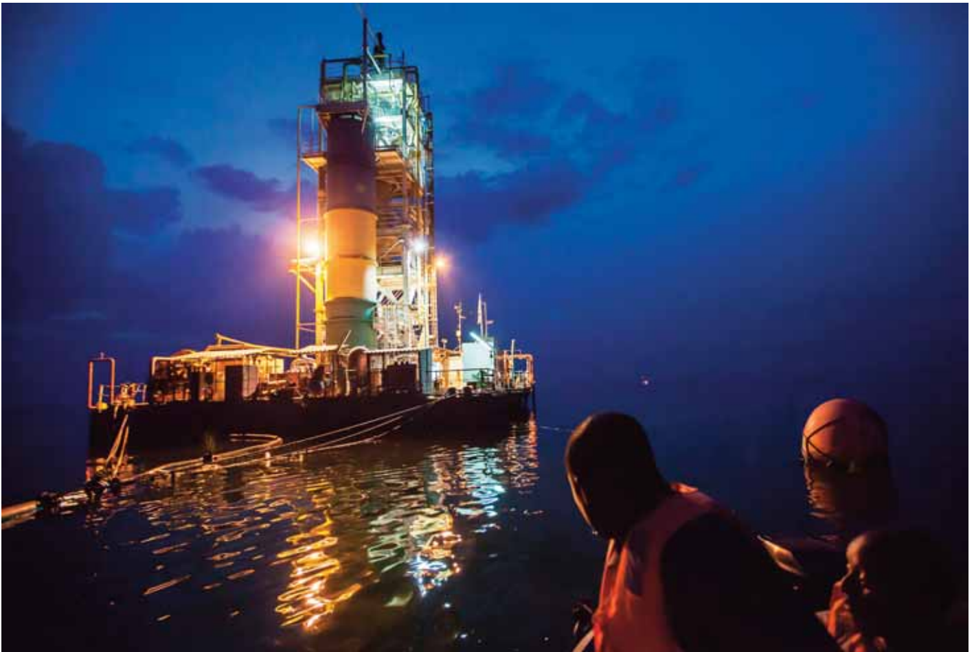
Abb. 5: Methansammelstation auf dem Kiwu-See/Ruanda.
