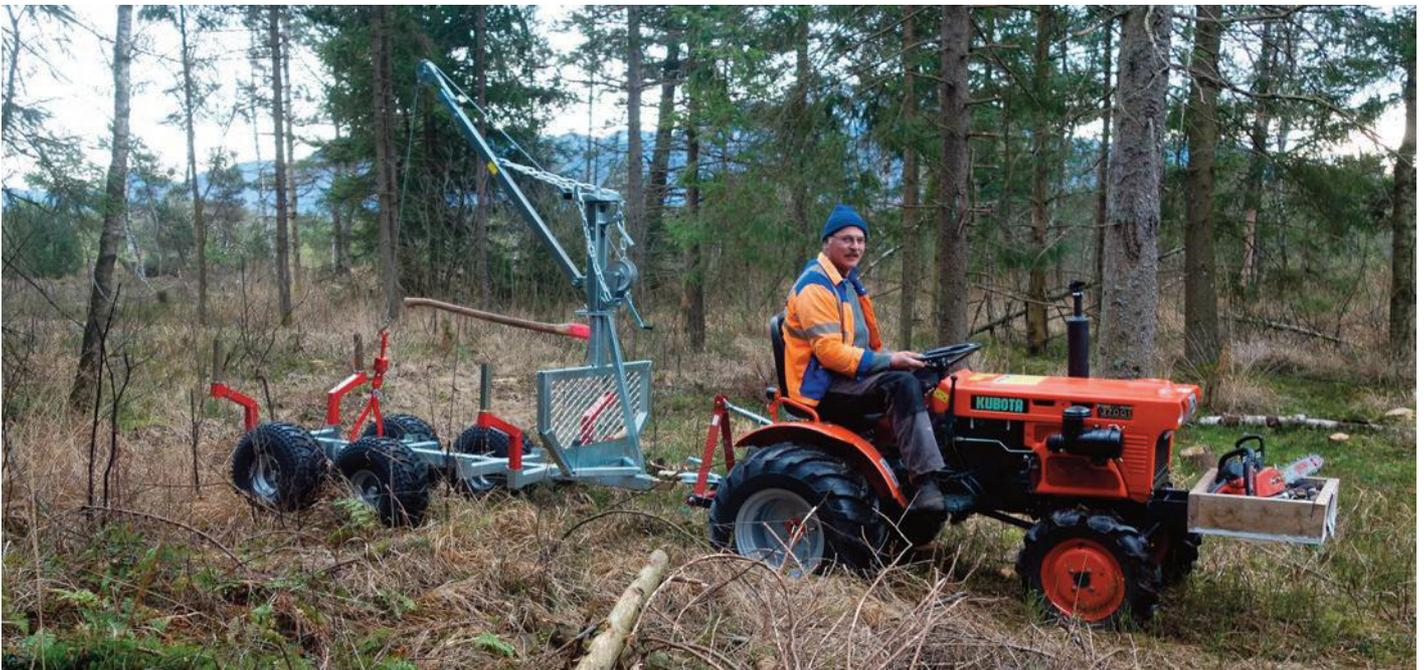
Abb. 1: Leichtgewichtiger Moorkleintraktor im Moorwald mit spezieller Moorbereifung zur weitestgehenden Schonung des Waldbodens. Die Rückegassen können eng gehalten werden. Gerückt wird per Winde.
