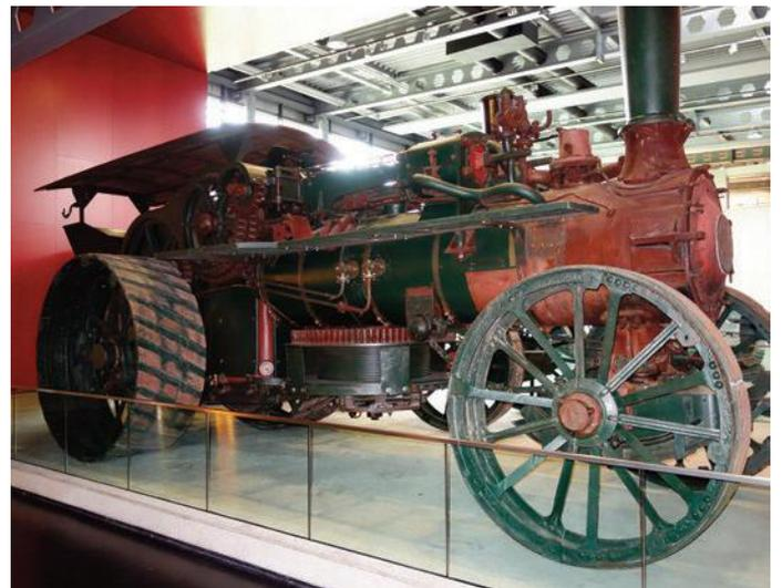
*Abb. 5: Pflug-Lokomobile mit waagrecht liegender Seilwinde (unter dem Kessel).*
