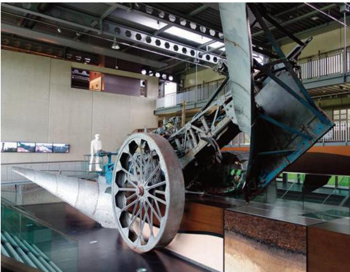
*Abb. 4: Moorkippflug: in beide Schlepprichtungen wirkender Tiefpflug (Moormuseum Emsland). Schleppbetrieb über Seilzug von stationären Lokomobilen aus. Es wurden für den Betrieb zwei Lokomobile benötigt, die an gegenüberliegenden Rändern des Arbeitsareals aufgestellt wurden.*
