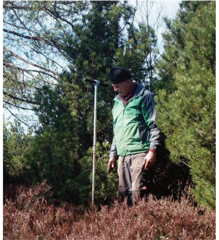
*Abb. 2a: Filzler Kurt Heinfling mit Moorsonde. Am unteren Ende der Sonde befindet sich die Probenkammer. Solche Moorsonden können bis zu 10 m Tiefe in Torfböden eingesetzt werden.*
