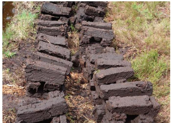
Abb. 1: „Moorfrische“ Torfziegel aus manuellem Torfstich, ausgelegt zur Lufttrocknung (Kendlmühlfilzen 2017).
