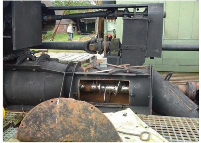
Abb. 8b: Gehäuse mit Messerschnecke, offen.
