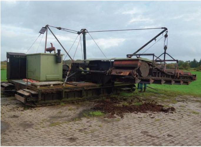
Abb. 8a: Noch aktiver Torfbagger mit integrierter Torfmaschine (Ostfriesland 2017).
