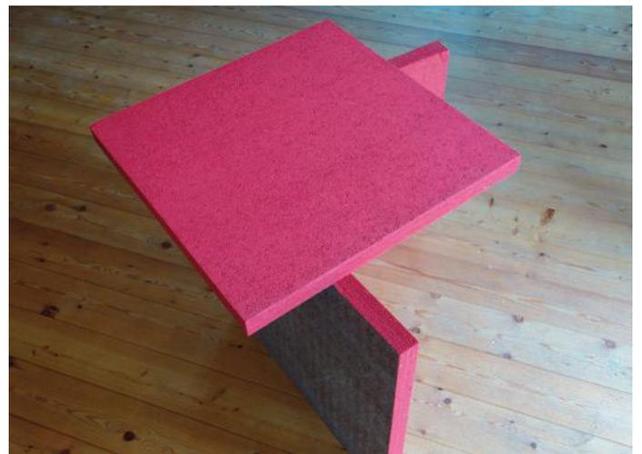
Abb. 5: Schallschutz Torf.
