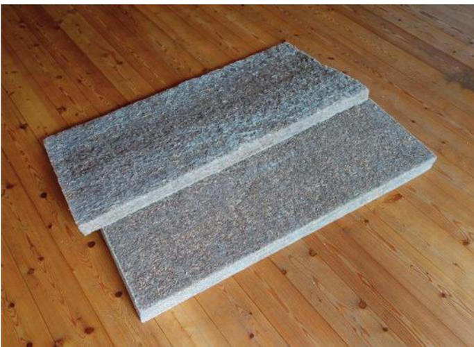
Abb. 4: Wärmedämmungselement Torf.
