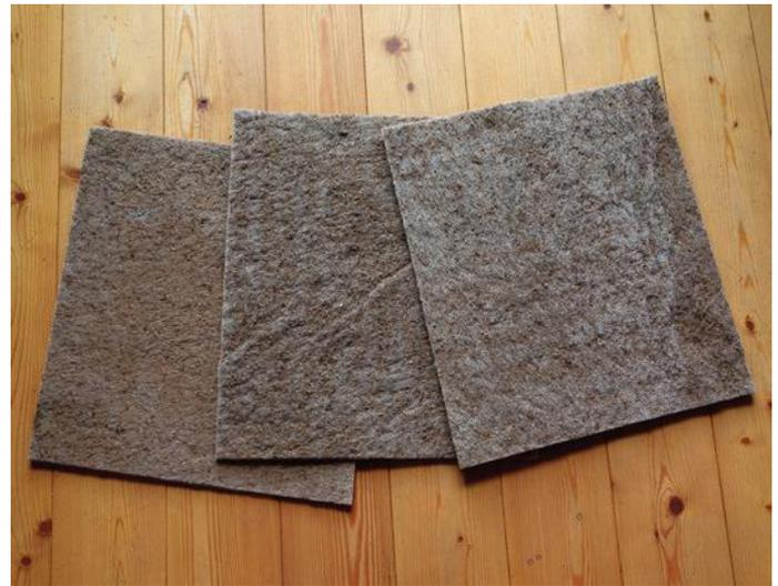
Abb. 8: Vliese aus Fasertorf zur Aufnahme öligere Substanzen Format 40x40x1cm<sup>3</sup> (Fa. Konto).
