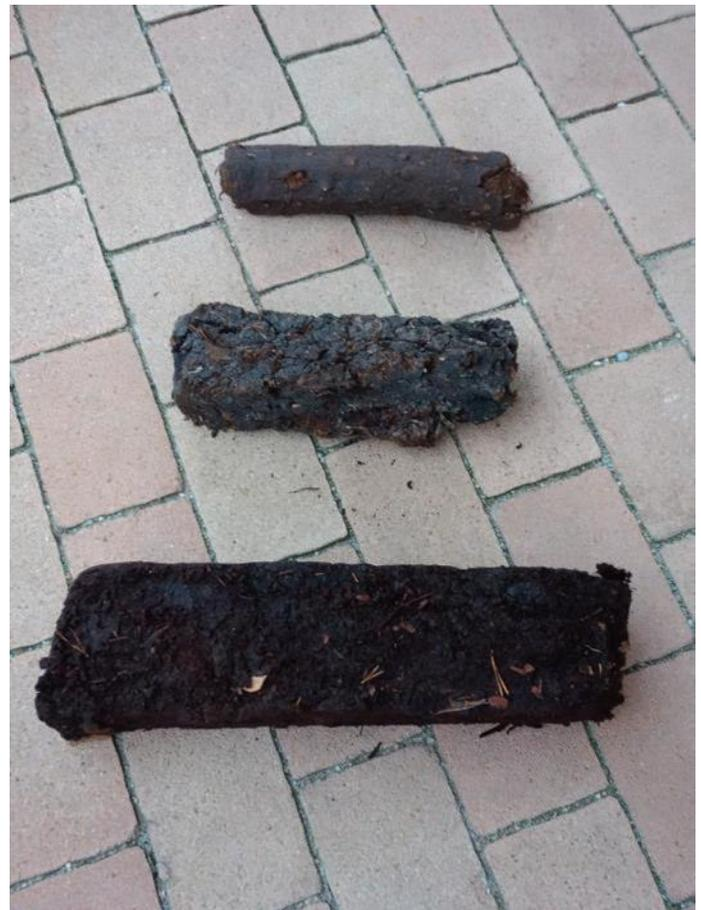
Abb. 7: Vergleich: Nasser Stichtorf, moorfrisch (vorne); Stichtorf, luftgetrocknet (Mitte); Maschinentorf (hinten). Alle drei Muster enthalten ungefähr die gleiche Torftrockenmasse.
